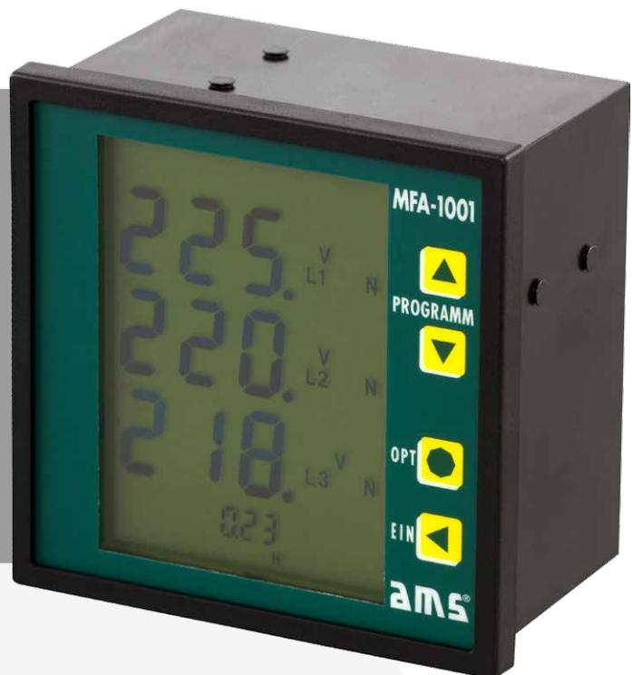
Bei der MFA-1001 mit LC-Display sind alle Grundfunktionen im Vierleiter Niederspannungsnetz verfügbar. Optional kann ein Schaltausgang / Impulsausgang ergänzt werden. Durch das große LC-Display ist eine exakte und blendfreie Ableseung möglich. Eine übersichtliche Bedienung und einfache Parametrierung erleichtert die individuelle Darstellung der Messwerte.
