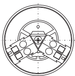
Einphasiger Kondensator mit d = 60/70 mm Anschlussklemmblock AKD 25/2 für 2 × 6 mm 2 Art.-Nr. 31-08002
